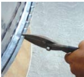
Figura 48. Corte de pestañas.
