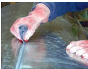
Figura 34. Lijar la superficie para quitar el galvanizado.
