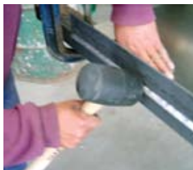
Figura 14. Quiebre y apertura de la pestaña.
