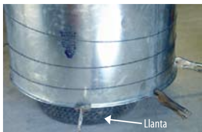
Figura 74. Colocar el cilindro en una llanta para no maltratar el cono.
