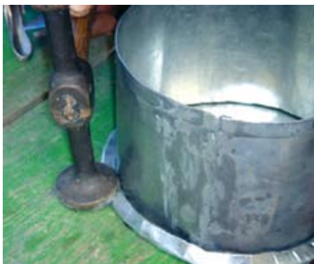
Figura 85. Asentar hasta que el cilindro quede dentro de la tapa.
