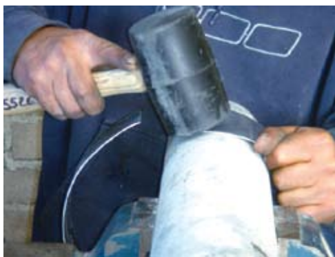
Figura 80. Darle forma circular a las tapaderas. Si es necesario, utilizar un mazo pero sin quebrar el doblez.
