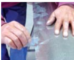
Figura 4. Marcar con el gramil.
