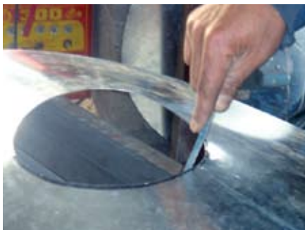
Figura 68. Limar para quitar el filo de la abertura.
