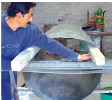
Figura 30. Cuidar que la lámina no se deforme.
