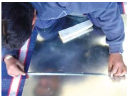
Figura 52. Marcar la circunferencia para formar el cono.
