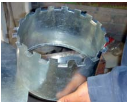
Figura 67. Doblado de pestañas alternadas.
