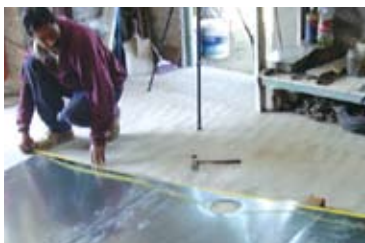
Figura 25. Medir que la longitud sea uniforme.
