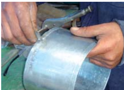
Figura 83. Marcar con el gramil.
