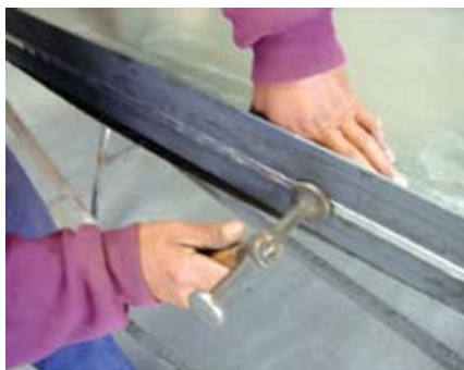
Figura 10. Asentamiento del doblez con un martillo hojalatero.
