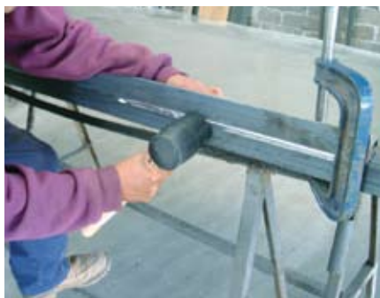
Figura 9. Posición de la mano y doblado con el mazo.
