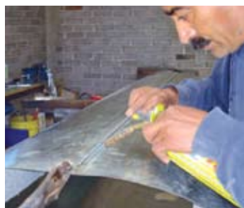
Figura 36. Calentar la soldadura.
