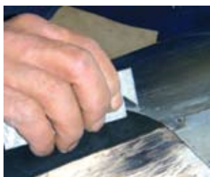
Figura 39. Marcar con el gramil.
