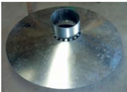
Figura 69. Colocar el cuello en el cono, que no quede forzado.
