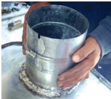
Figura 81. Medir antes de soldar toda la pieza.
