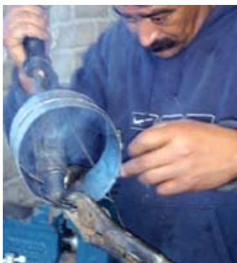
Figura 82. Soldar con caudín sin quitar las pinzas.
