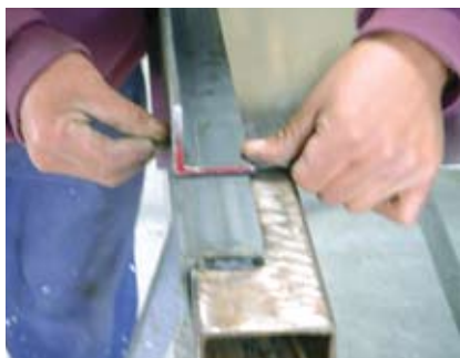
Figura 8. Preparación de la lámina para doblar la pestaña.
