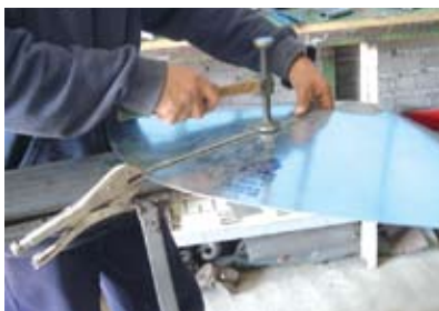
Figura 61. Utilizar pinzas para sujetar el empalme.
