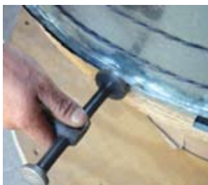
Figura 49. Levantar pestañas con el martillo.
