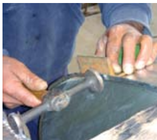
Figura 41. Asentar la pestaña con base circular.
