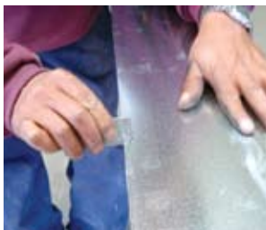
Figura 12. Medición con el gramil. Figura 13. Detalle del doblé.
