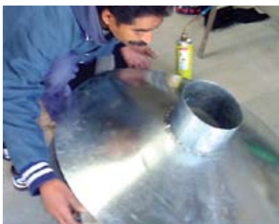
Figura 72. Encontrar la posición adecuada para que no se escurran ni el ácido ni la soldadura.
