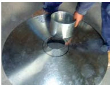
Figura 66. Marcar y ajustar la circunferencia del cuello de entrada en el cono.
