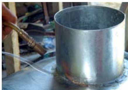
Figura 79. Soldar el cuello con la base del cilindro.
