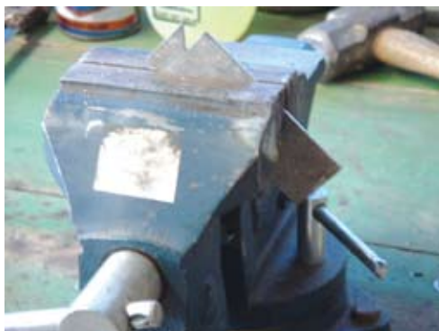
Figura 2. Fijación de la lámina en el tornillo.
