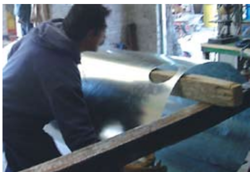
Figura 38. Girar el cilindro para soldar la siguiente hoja.
