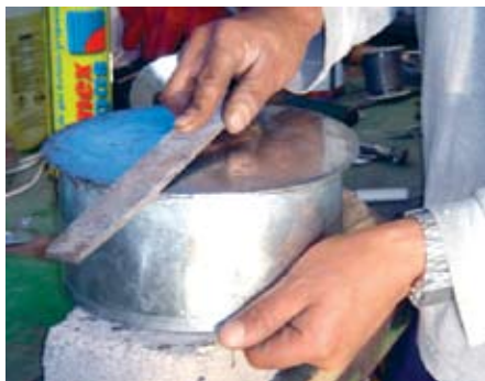
Figura 87. Limar las orillas porque ésta es una pieza que será utilizada con frecuencia.
