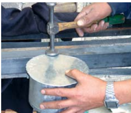
Figura 86. Asentar la parte de donde se asirá la tapadera.
