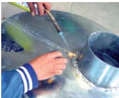
Figura 73. Soldar la parte del cuerpo del cono.
