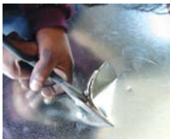
Figura 19. Cortar con las tijeras.
