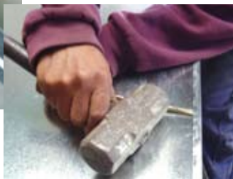
Figura 14. Quiebre y apertura de la pestaña.
