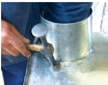
Figura 78. Asentar las pestañas por dentro y por fuera con una base firme.
