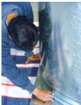
Figura 44. Marcar sobre la lámina.
