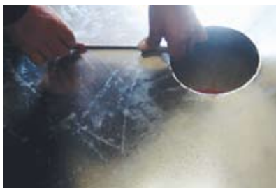
Figura 60. Marcar la pestaña.
