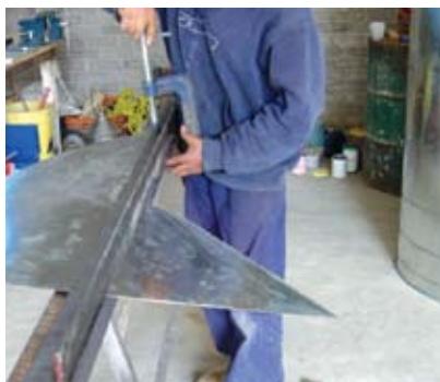
Figura 56. Doblado de la pestaña del cuerpo del cono.
