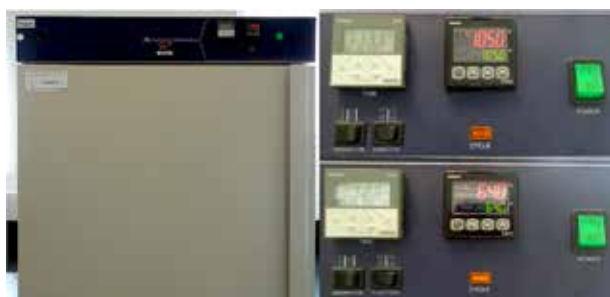
Figura 46. Acondicionamiento de estufa.
