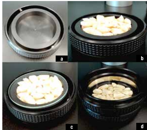
Figura 116. a) Base de la cápsula, b) Aro para delimitar la cantidad de muestra, c) Cuarzo anti-reflejante, d) Cabezal de la cápsula.
