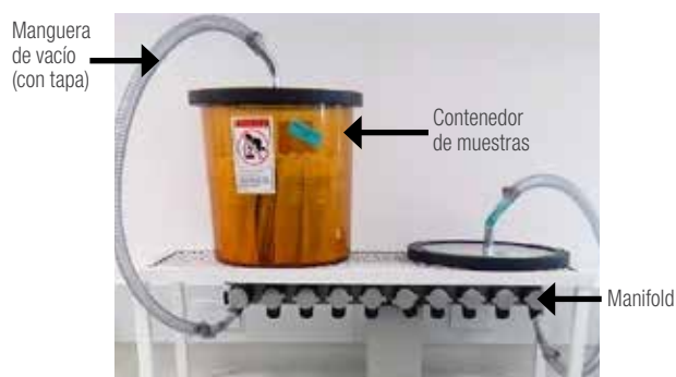
Figura 20. Manifold y base para contenedor.
