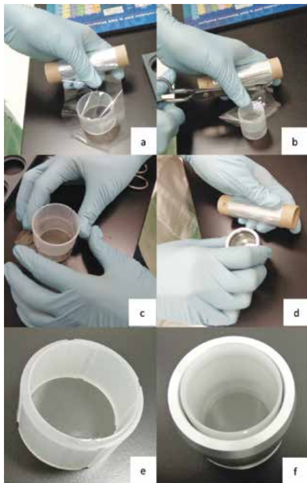
Figura 226. Colocación de la película de polipropileno
