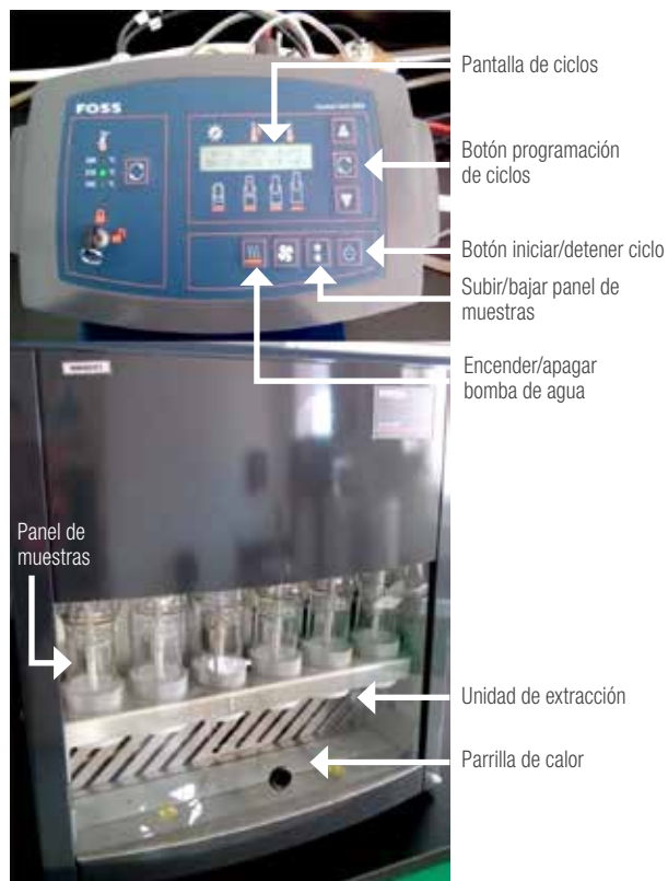
Figura 162. Descripción del equipo de extracción etéreo Soxtec.
