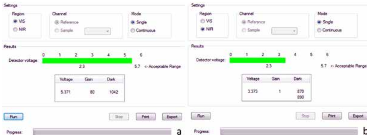
Figura 154. Resultados del Gain test; 154a, para región visible y; 154b, para región NIR.
