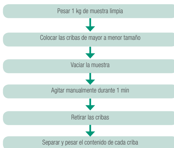
Figura 69. Diagrama de flujo de la determinación del tamaño de grano por distribución.
