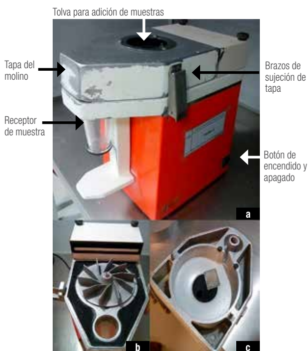
Figura 28. a) Descripción general del molino ciclónico; b) Rotor con aspás; c) Vista interna de la tapa.
