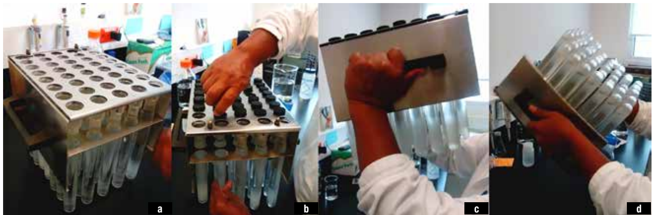
Figura 195. a) Gradilla de tubos con muestra, b) Tapones de tubos, c) y d) Agitación de la gradilla con tubos.
