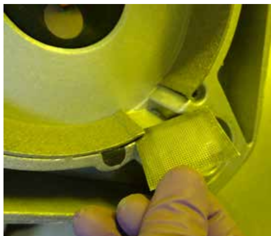
Figura 29. Colocación de la malla de 0.5 mm de diámetro.
