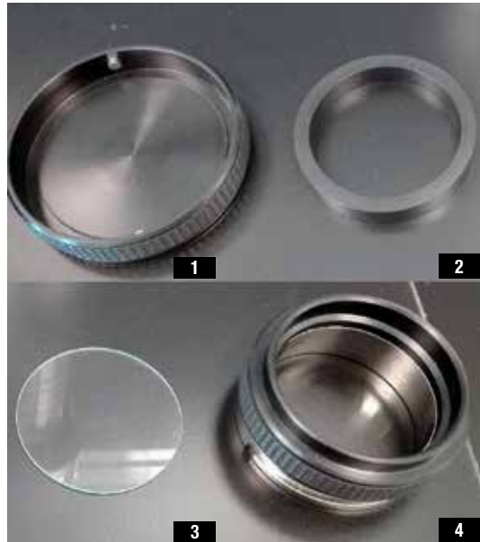
Figura 115. 1) Base de la cápsula, 2) Aro para delimitar la cantidad de muestra, 3) Cuarzo antirreflejante, 4) Cabezal de la cápsula.
