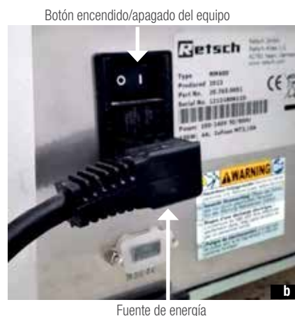
Figura 32. a) Descripción frontal del molino de bolas MM 400, b) Descripción trasera del molino de bolas MM400.
