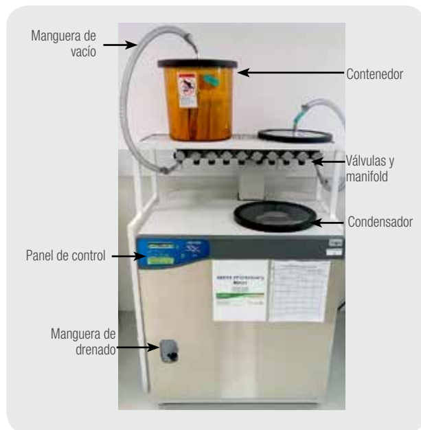
Figura 17. Liofilizador LABCONCO Mod. 7755041.
