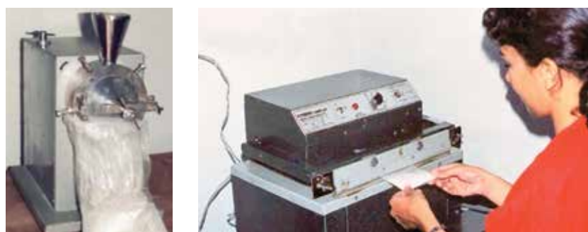
Figure 3. Fraisage et emballage. Fraisage de la formulation mouillable de Baculovirus (à gauche) ; Baculovirus emballé pour l'application sur un hectare de maïs (à droite).
