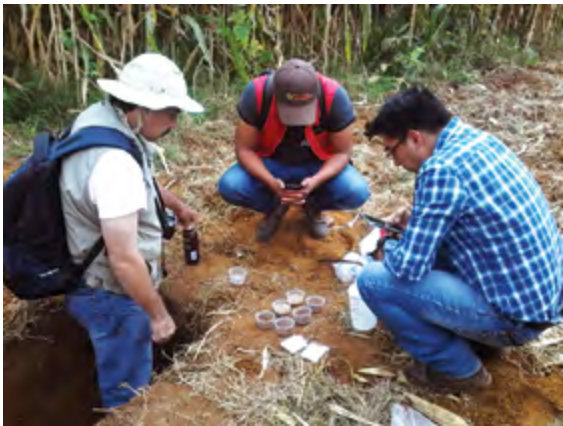
10 de octubre de 2017. Santa Cruz Xoxocotlán, Oax. Los ingenieros Fernando García Dávila, Samuel Randy Aracén Molina y Fermín Martínez Hernández realizan la medición de pH y materia orgánica, a diferentes profundidades del perfil, en la plataforma de investigación.
