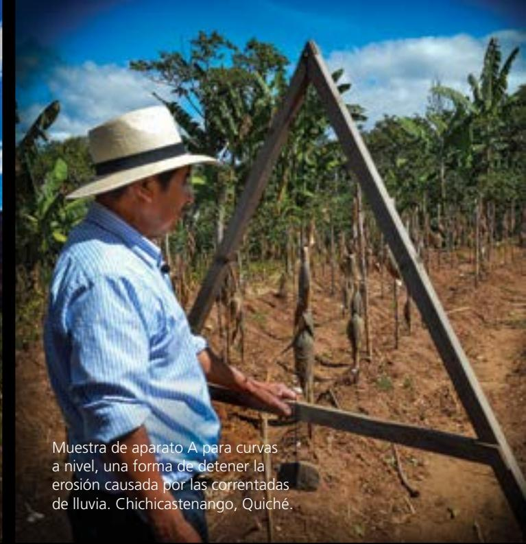
Muestra de aparato A para curvas a nivel, una forma de detener la erosión causada por las correntadas de lluvia. Chichicastenango, Quiché.
