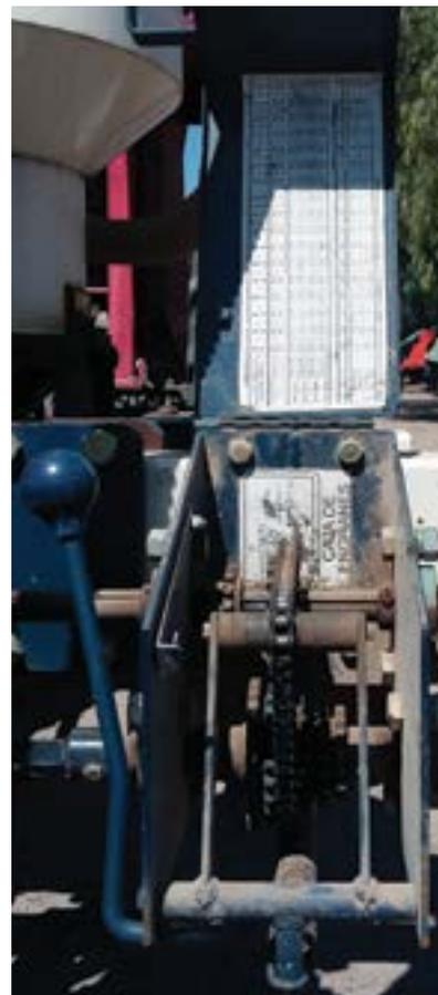
**Paso 6.** Accione la toma de fuerza, cuidando que las revoluciones del motor oscilen entre 1,700 y 1,900 rpm, logrando tener 540 rpm a la toma de fuerza, esto garantizará que la succión generada por la turbina logre fijar la semilla en los barrenos del plato de dosificación.
