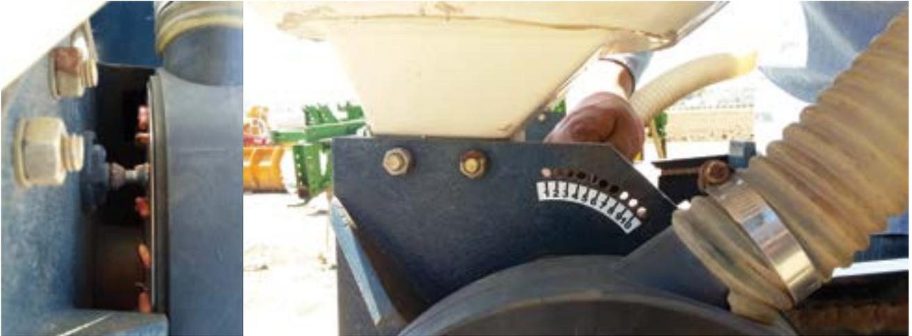
**Paso 8.** Realice un recorrido de prueba para verificar que la configuración de engranes es la adecuada para lograr la densidad de siembra deseada y el distanciamiento entre semillas.
