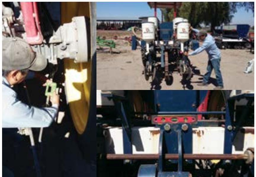
**Paso 3.** Conectar la flecha cardan de la turbina a la toma de fuerza del tractor.
