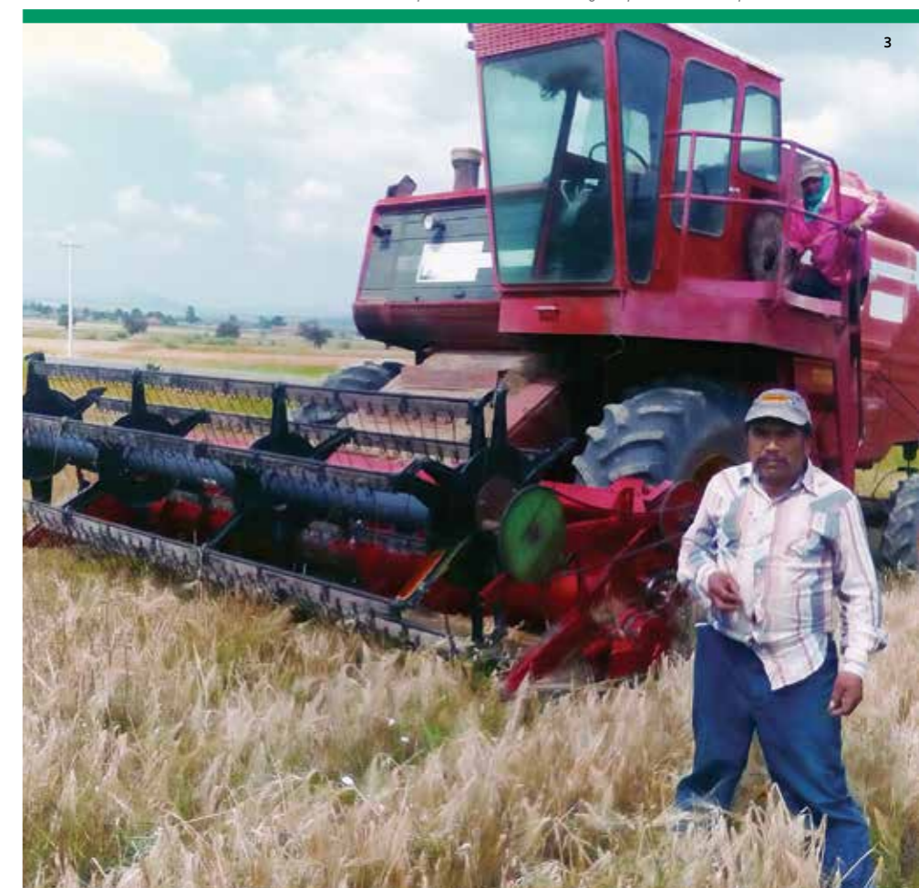
Foto 3. El productor debe revisar los componentes de la trilladora, calibrarla y supervisar el terreno para calcular la cantidad de grano para disminuir las pérdidas.
