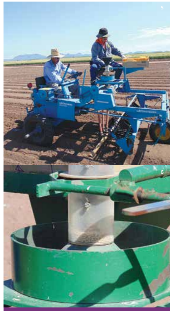
Foto 5. Siembra tardía de los experimentos evaluados bajo condiciones de calor. Foto 6. Detalle de la semilla de trigo dentro de la sembradora antes de caer por los chusos para la siembra.
