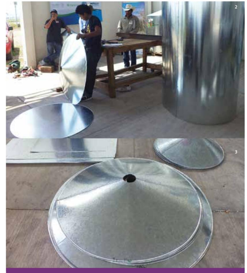
Foto 2. Armado manual de las piezas del silo metálico hermético. Foto 3. Lámina galvanizada calibres 24 y 26.
