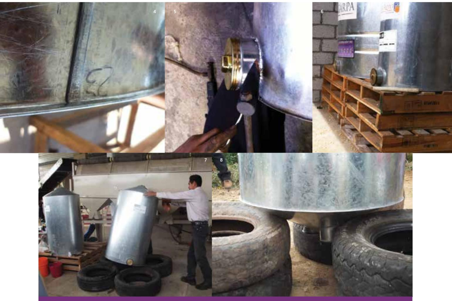
Foto 4. Engargolado y adecuada soldadura de todas las uniones del SMH. Foto 5. Alternativa de tapón metálico para SMH. Foto 6. Ubicación adecuada del SMH. Foto 7. Prueba practica de hermeticidad en SMH con uso de agua. Foto 8. Prueba básica de hermeticidad en SMH con uso de agua.
