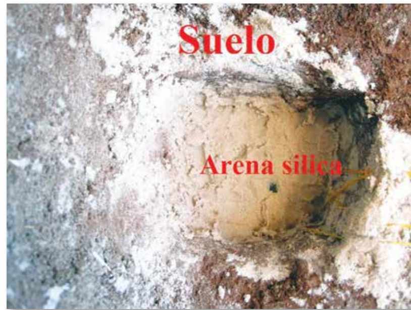
Figura 3. Túnel relleno con caja de resina y arena silica listo para cerrarse.
