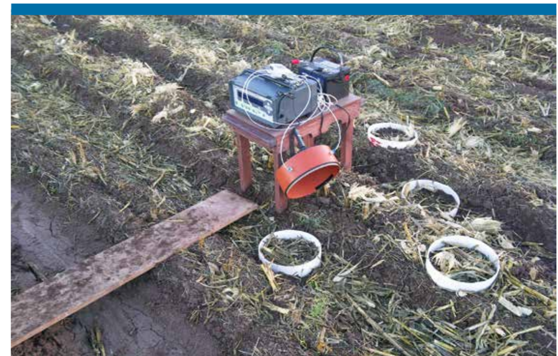
Figura 4. Colocación de anillos, aparatos y tabla en campo.
