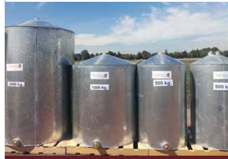
Silos metálicos herméticos.
