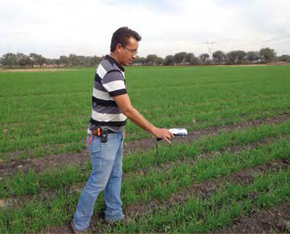
Uso de sensor GreenSeeker™ en cultivos de trigo y maíz para manejo eficiente de fertilizantes nitrogenados.
