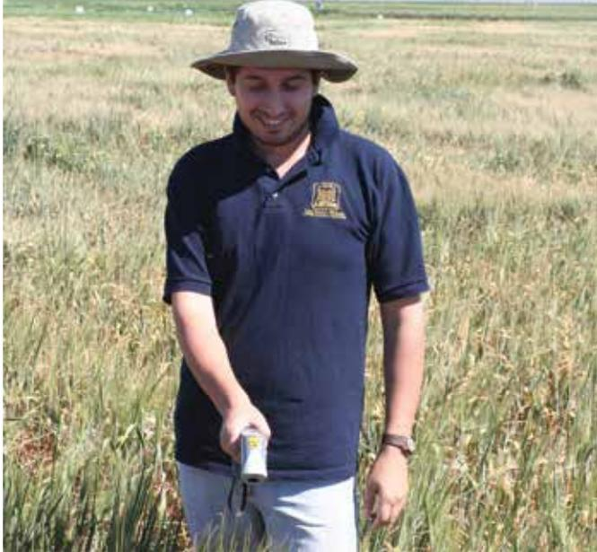
**USO DE TERMÓMETRO DE INFRARROJOS para medir la temperatura de la cubierta del dosel.**
