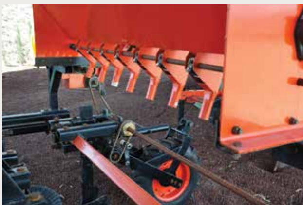
AQUÍ VEMOS UN EJEMPLO DE FERTILIZADORA-REFORMADORA con la dosificación de fertilizante.
