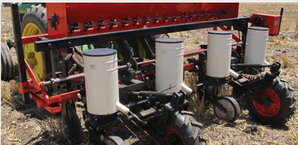
LA ÚLTIMA VERSIÓN DE LA MÁQUINA MUMC PARA TRACTOR DE CUATRO RUEDAS. Cuenta con un sistema mejorado para sembrar semilla grande, sistema de cilindro acanalado para la siembra de semillas pequeñas y realiza reformación de camas con un mínimo de disturbio en el suelo.
