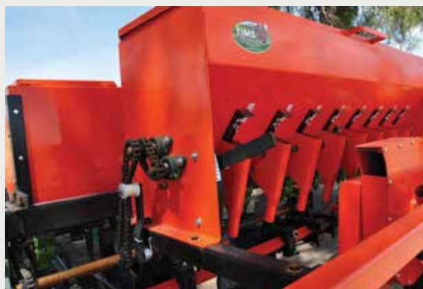
INTEGRACIÓN DEL SISTEMA DE FERTILIZACIÓN en una máquina MUMC, que facilita los procesos de siembra y fertilización con mayor precisión.
