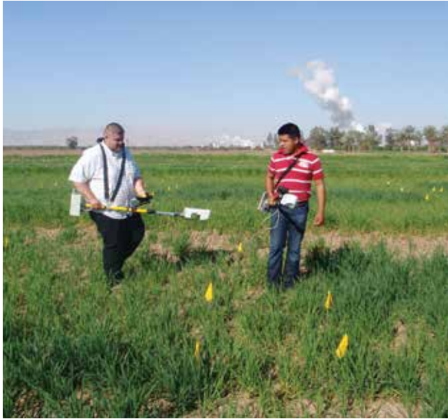
FIGURA 5. Uso del sensor GreenSeeker™ en los campos de Baja California.
