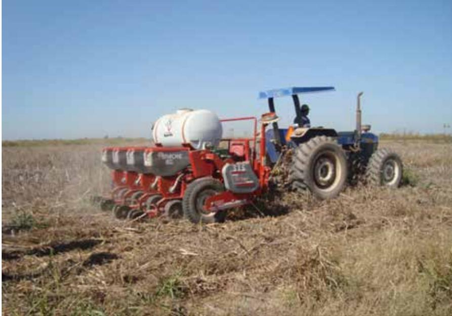
Figura 4. Equipo de siembra y fertilización de maíz (INIFAP-Cevaf, 2011).
