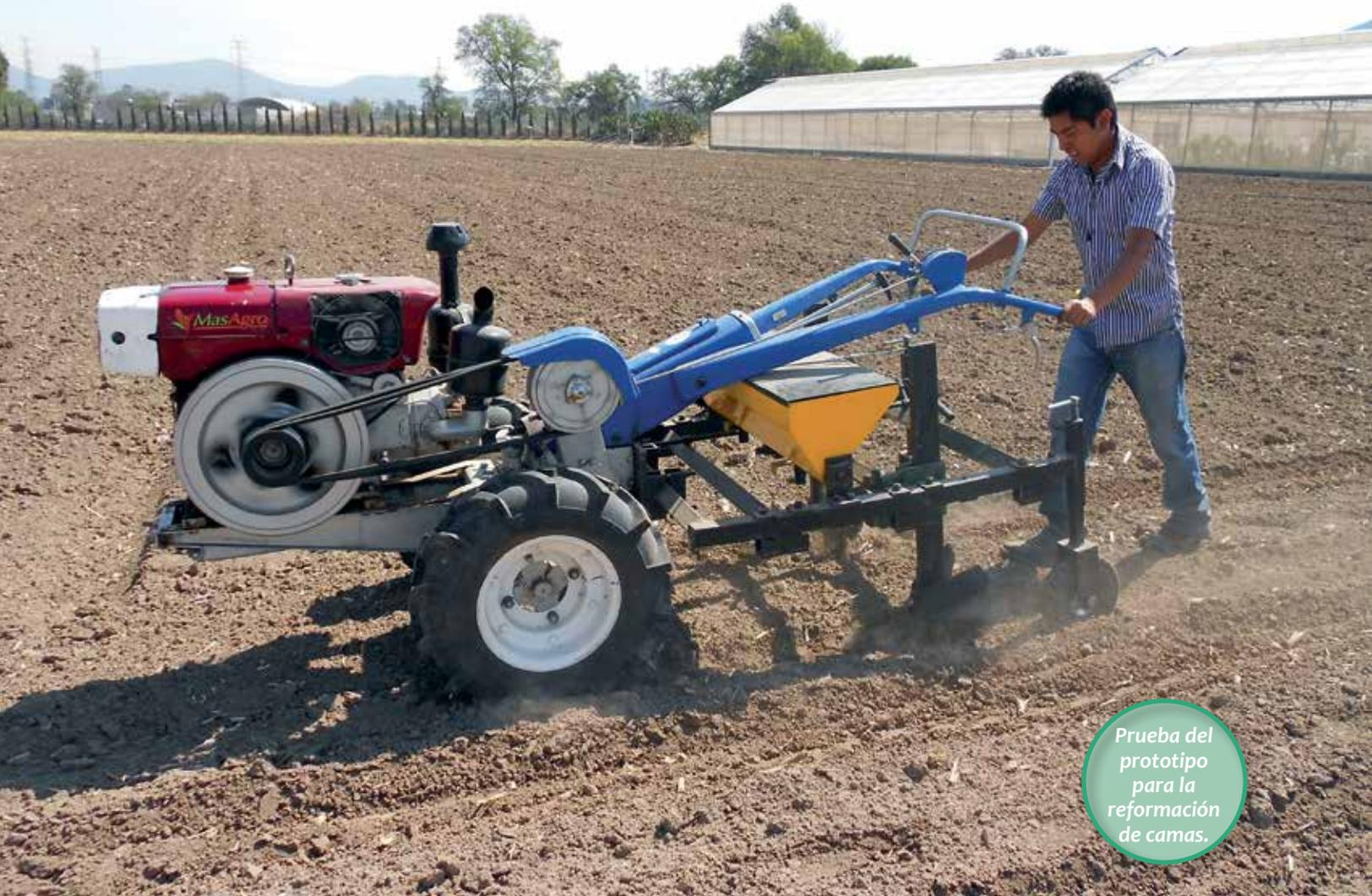
Prueba del prototipo para la reformación de camas.
