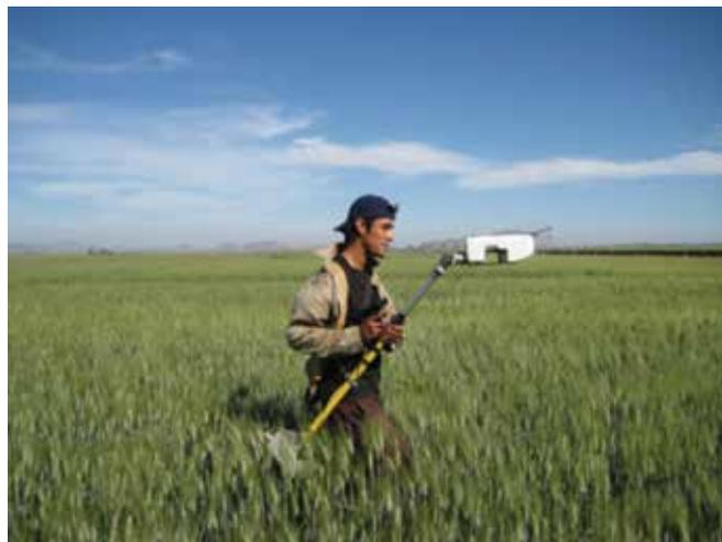
Figura 2. Persona sosteniendo el sensor GreenSeeker™ por encima de la superficie del cultivo, mientras camina a velocidad lenta para que éste recoja las mediciones NDVI.
