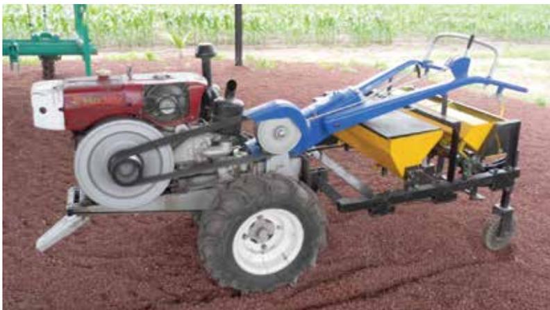
Figura 1. Prototipo de la máquina multiusos-multicultivos acoplada a un tractor de dos ruedas Dong Feng de 15 HP.
