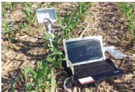
Figura 7. Sensor de humedad y temperatura del suelo (INIFAP-Cevaf, 2011).
