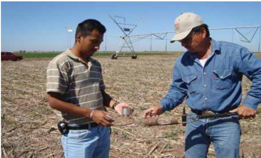
Figura 5. Extracción del suelo para determinar sus propiedades físicas y químicas (INIFAP-Cevaf, 2011).
