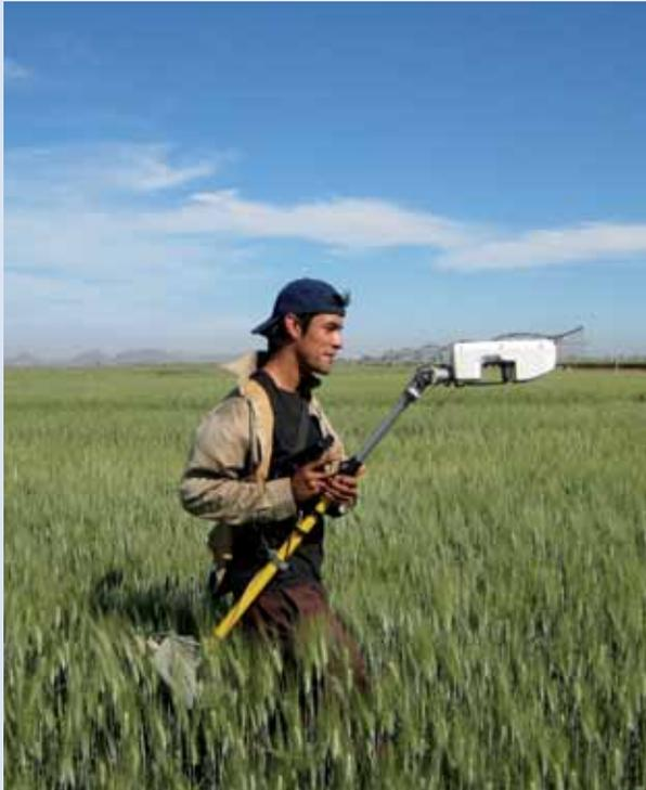
**Figura 3: Persona sosteniendo el Greenseeker™ sobre la superficie del cultivo mientras camina a baja velocidad y mide los valores del NDVI.**
