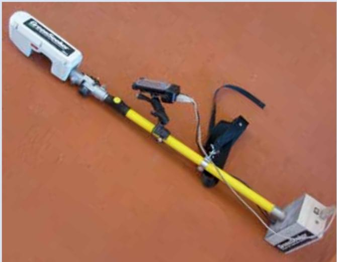
Figura 2: Greenseeker™ sensor óptico manual.
