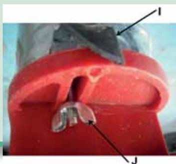
Por lo que, se debe deslizar el limitador de apertura: su pieza de plástico 1, hacia fuera del depósito hasta que sean los 320 gramos, en los 30 golpes de siembra.
