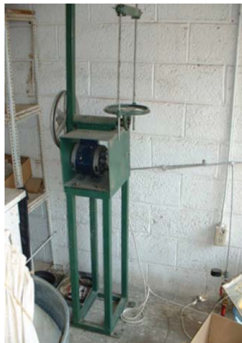
Figura 1. Máquina utilizada para agitar las muestras de suelo seco.
