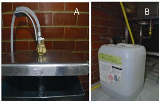
Figura 15. (A) Tapa del tanque con una conexión al suministro de agua o recipiente que contiene colchicina; (B) recolección de los residuos desde la apertura del fondo.
