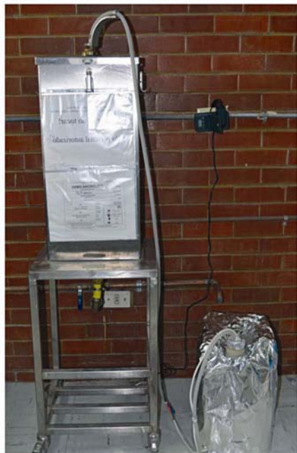
Figura 14. Tanque y bombeo de solución de colchicina del contenedor al tanque.
