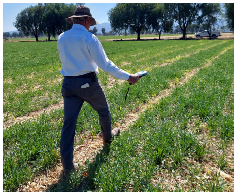
Figura 2. Medición del valor NDVI a los 37 DDS en cultivo de cebada con diferentes fuentes de fertilización y fraccionamiento de nitrógeno. Ciclo OI 22-23
