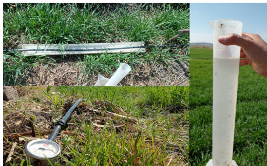
Figura 1. Medición de la presión en cintilla de riego del sistema de riego por goteo y aforo de emisores. Ciclo OI 22-23, Plataforma de Investigación Irapuato I.
