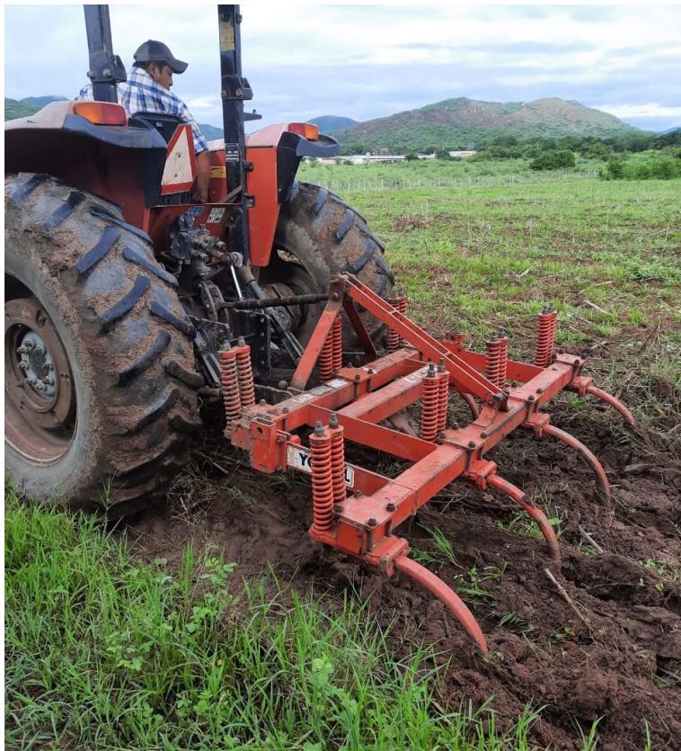
■ Figura 4. Descompactación del suelo como práctica de acondicionamiento empleando el arado de cinceles vibratorio, plataforma Villa Corzo, Chiapas. Ciclo PV 2016.
