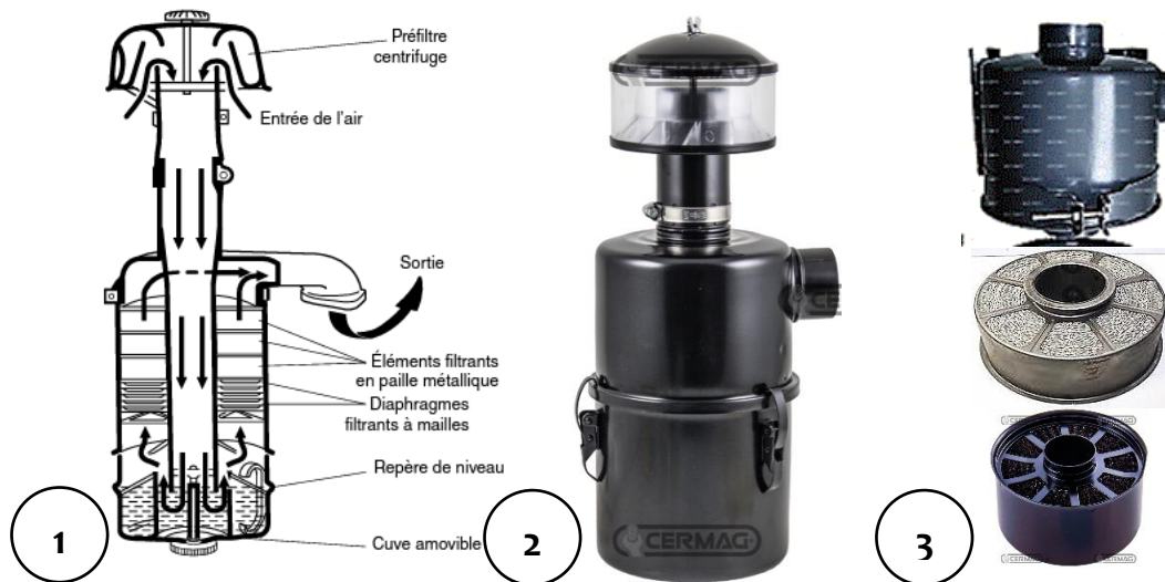
(1) Schéma descriptive d'un Préfiltre & filtre à bain d'huile | (2) & (3) Ensemble monté et détail du filtre à bain d'huile.
