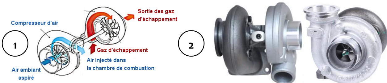
(1) Schéma descriptive du fonctionnement d'un turbo compresseur | (2) photo d'un turbo compresseur.
