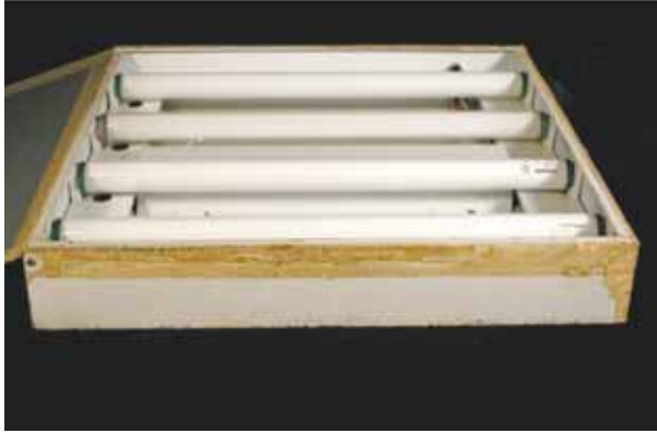
Figura 9. Colocación de los focos en una mesa de luz de tipo (b).
