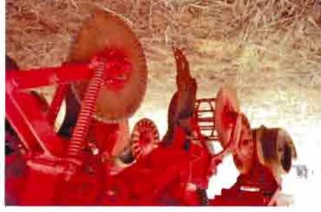
Siembra directa sin mover el suelo. Un disco cortador abre el suelo, se deposita la semilla y la llanta compactadora cierra la abertura.
