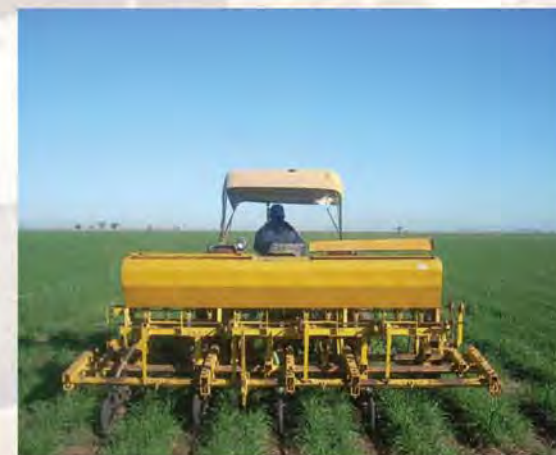
Máquina Multiusos-Multicultivo , consta de tres barras paralelas donde están montados todos los componentes, los cajones y los mecanismos de siembra.
