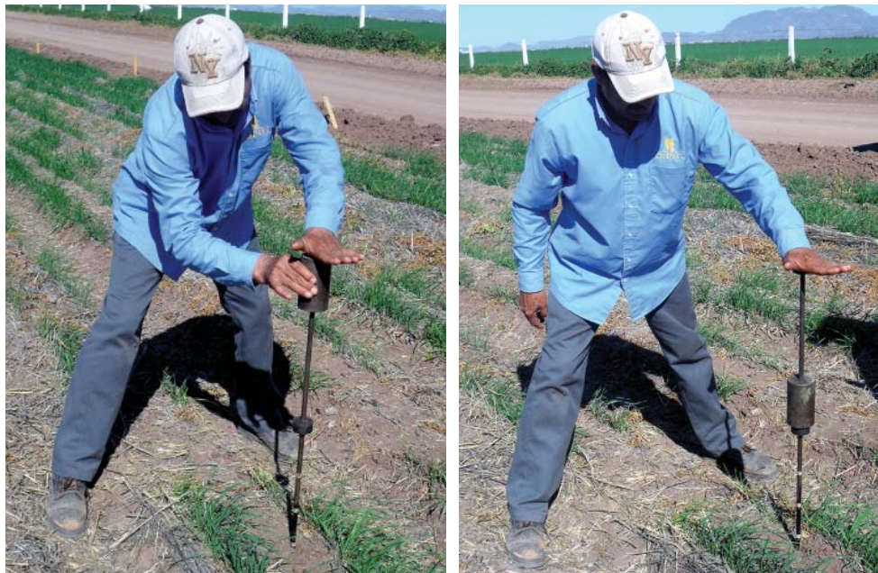
Figura 1. Utilización del penetrómetro. Izquierda: la pesa se sube hasta la punta superior del penetrómetro; derecha: la pesa se deja caer y esto cuenta como el primer impacto.
