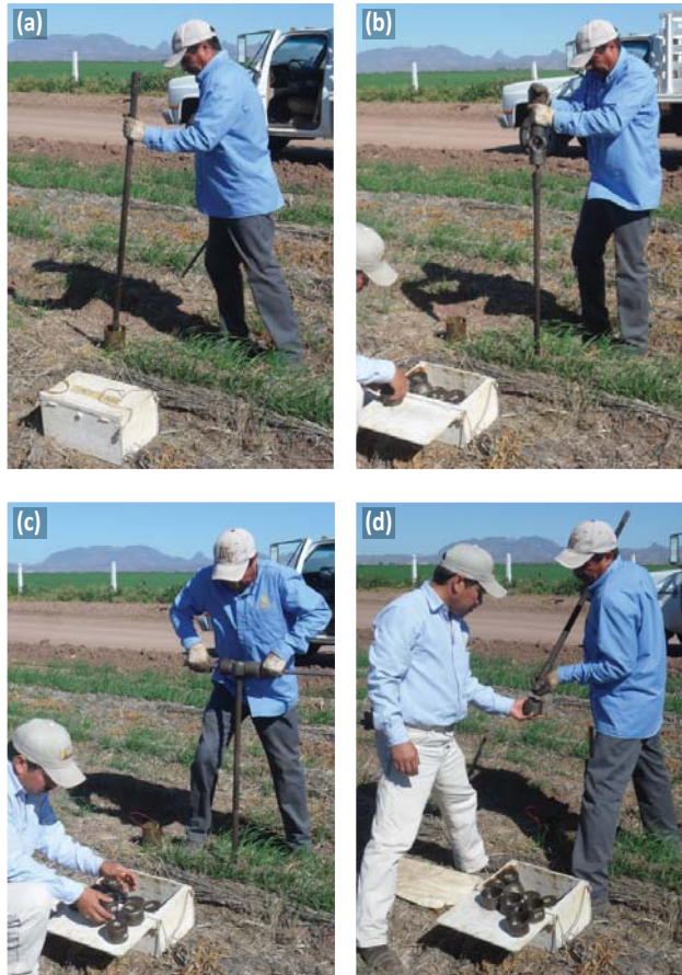
Figura 1. Los cuatro pasos requeridos para tomar las muestras: a) se engrasa la punta; b) se clava la barrena; c) se saca la barrena; y d) la muestra se coloca en una lata de metal.
