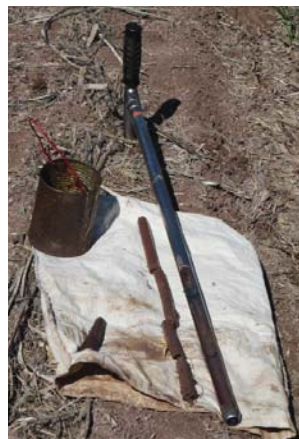
Figura 3. Equipo: barrena pedológica, la muestra de suelo y una lata de aceite.
