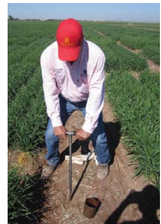
Figura 4. Utilización de una barrena pedológica en el campo.
