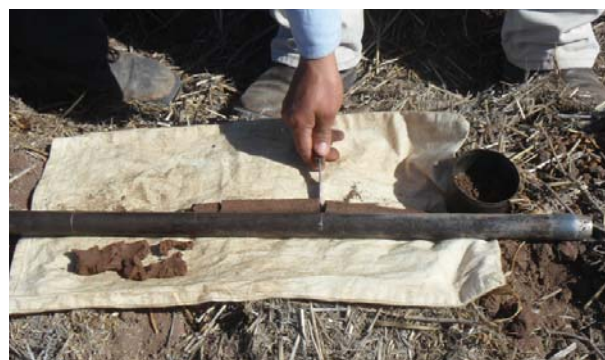
Figura 2. Para mejorar la eficiencia, es posible muestrear más de una profundidad al mismo tiempo. Para hacerlo, la muestra se extiende sobre un pedazo de tela o plástico, y la barrena se utiliza como regla para dividir la muestra en las fracciones correctas.
