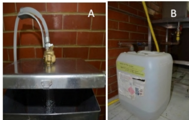
그림 15.(A) 물 공급이나 콜히친 용기와 연결된 콜히친 탱크 덮개; (B) 바닥 배출구에서 콜히친 폐기물 수집
