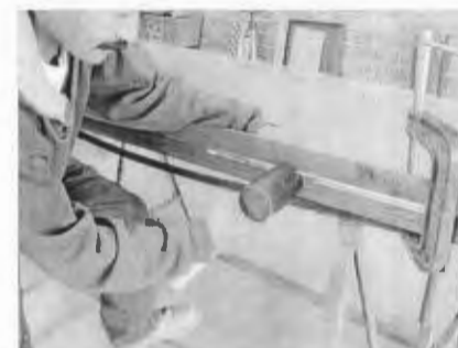
Figura 9. Posición de la mano y doblado con mazo
