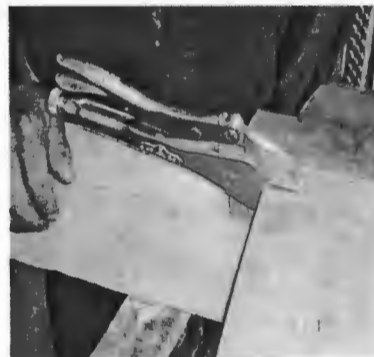
Figura 29 Ayúdese con pinzas de presión
