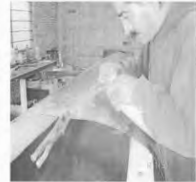
Fig. 36. Calentar la lámina.
