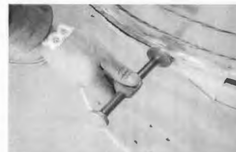
Figura 49. Levantando pestañas con martillo
