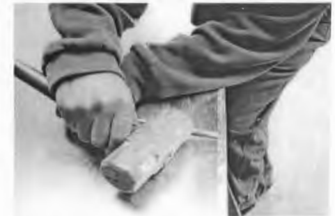
Figura 14. Quiebre y apertura de la pestaña
