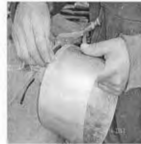
Figura 83. Marcar con gramil
