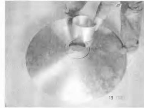
Figura 66. Marcar y ajuste la circunferencia del cuello de entrada en el cono
