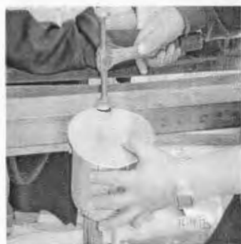
Fig. 86. Asentando la parte de donde se tomará la tapa para abrir.
