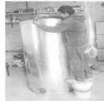
Figura 55. Cortado de la boca de entrada del cono
