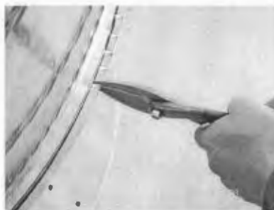
Figura 48. Corte de pestañas
