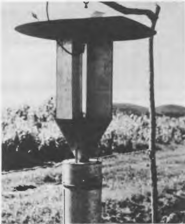
Figura 4. Trampa de luz para recolectar adultos de H. zea para establecer o renovar la colonia de laboratorio.
