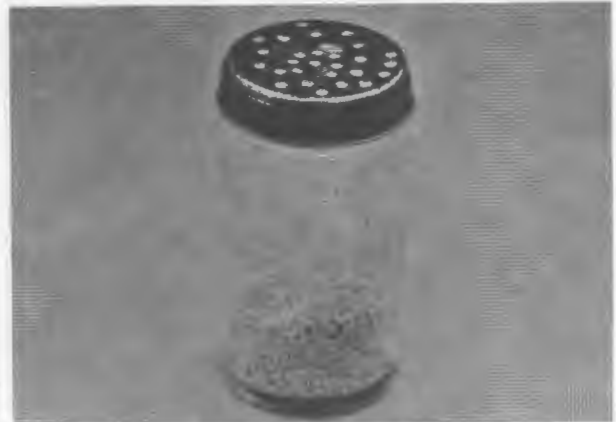
Figura 10. Envase sencillo para la infestación eficiente de las cajas de crianza con larvas de GC.
