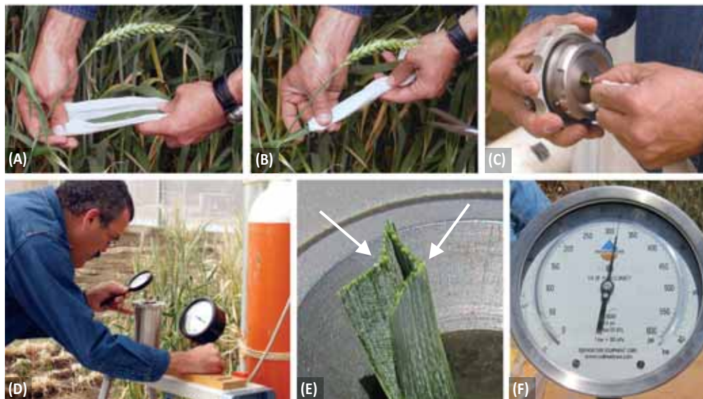
Figura 3.1. Equipo utilizado para realizar mediciones de potencial hídrico de la hoja, incluyendo la cámara de presión y el cilindro de aire comprimido.
