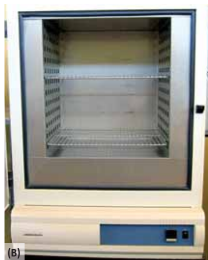
Figura 22.1. Hornos de secado: (A) horno de ventilación forzada de alta capacidad; y, (B) horno sin ventilación forzada de baja capacidad (adecuado para secar muestras en contenedores abiertos; por ejemplo, muestras de humedad de suelo).
