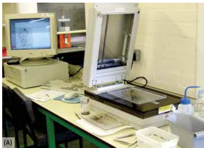
Figura 17.5. Escaneo de raíces: (A) escáner de raíces (WinRHIZO STD 1600+, Regent Instruments Inc., Quebec, Canadá); y (B) escaneo de una raíz de cebada (fotografía: Pedro Carvalho, Universidad de Nottingham).
