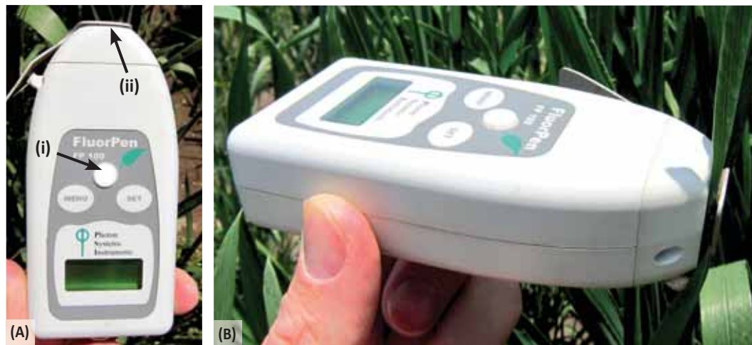
Figura 13.2. Fluorómetro de clorofilas de mano Fluorpen FP-100: (A) mostrando (i) sensor PAR, y (ii) una hoja en la cámara del sensor; (B) mediciones de campo en condiciones de luz natural.
