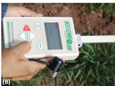
Figura 11.1 Toma de mediciones de interceptación de luz con un ceptómetro de mano: (A) mediciones debajo de la espiga; (B) ceptómetro Decagon AccuPAR LP-80; y, (C) mediciones en la etapa GS31, se muestra también el sensor externo siendo sostenido para mediciones simultáneas en el dosel.
