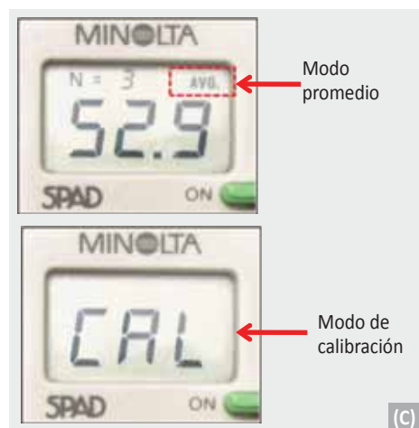
Figura 9.1. Uso del medidor de clorofila Minolta SPAD-502: (A) principales partes del instrumento; (B) medición en una hoja bandera en un punto medio, evitando que el sensor se ubique en la vena principal o nervadura, mostrando la lectura del índice de concentración de clorofila (ICC); y, (C) el 'modo promedio' y 'modo de calibración'.
