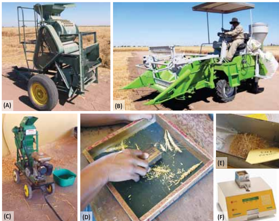
Figura 18.1. Cosecha para rendimiento y componentes de rendimiento: (A) cosechadora combinada para parcela; (B) trilladora estacionaria grande; (C) trilladora estacionaria pequeña; (D) trilla manual de una muestra; (E) muestra trillada que requiere limpieza final; y (F) contador de semillas (Pfeuffer GmbH, Kitzengen, Germany).
