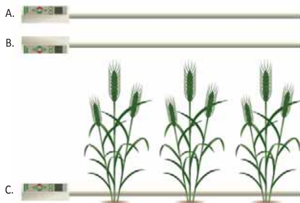
Figura 11.3 Tome mediciones para calcular la interceptación de luz, de: (A) PAR sobre el dosel; (B) reflectancia del dosel (con el ceptómetro volteado hacia abajo); y, (C) interceptación luz total del dosel.
