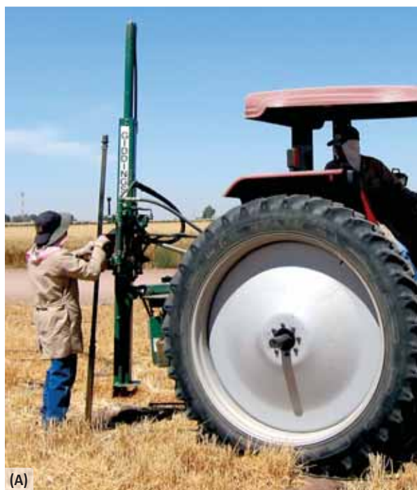
Figura 17.1. Muestreo de suelo utilizando (A) un tractor con una barrena de suelo hidráulica “Giddings”; y, (B) una barrena manual.
