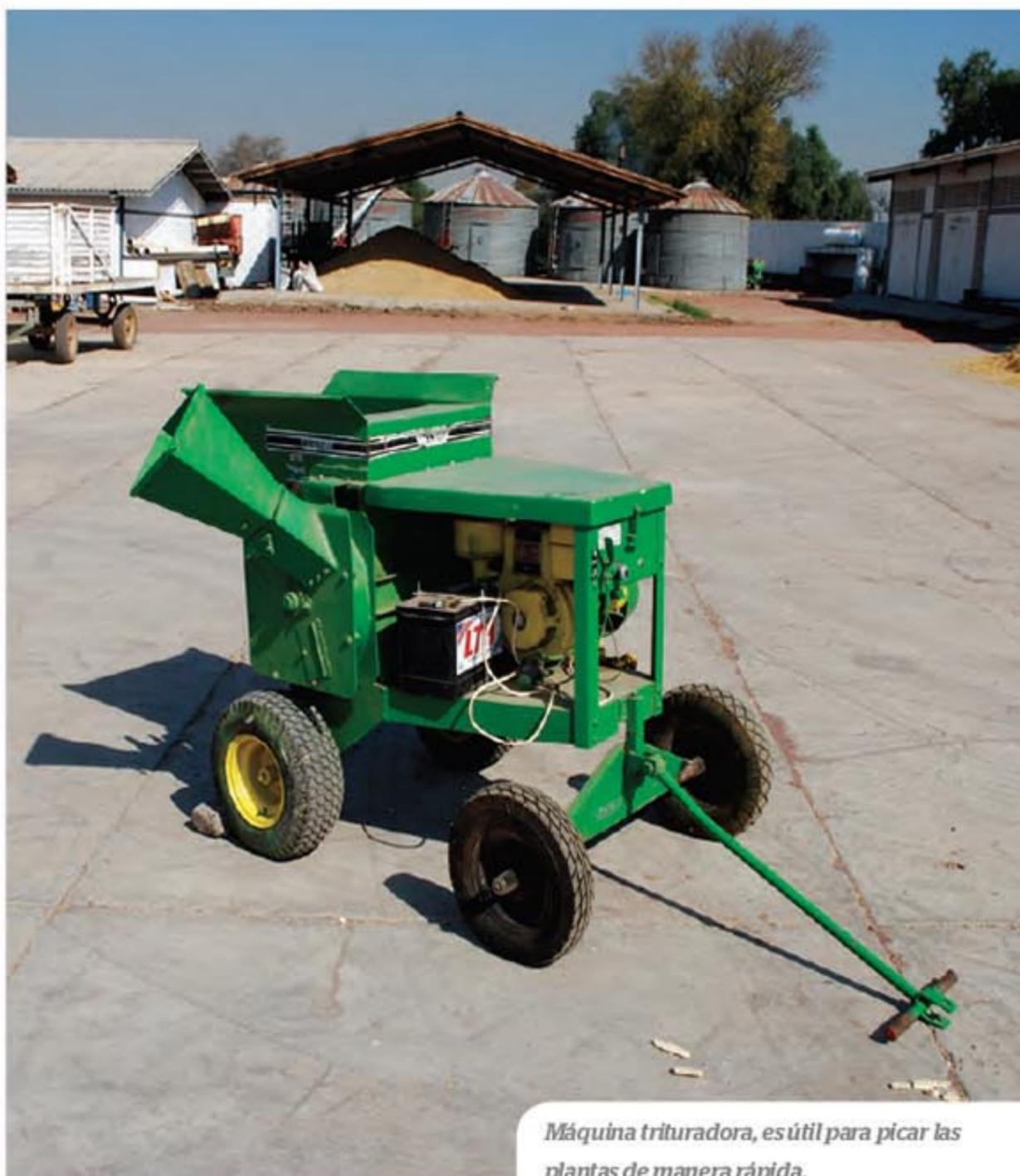
*Máquina trituradora, es útil para picar las plantas de manera rápida.*
