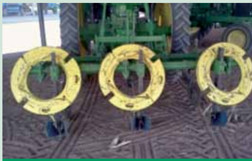
Figura 3. Reformadora con contrapesos lista para trabajar.
