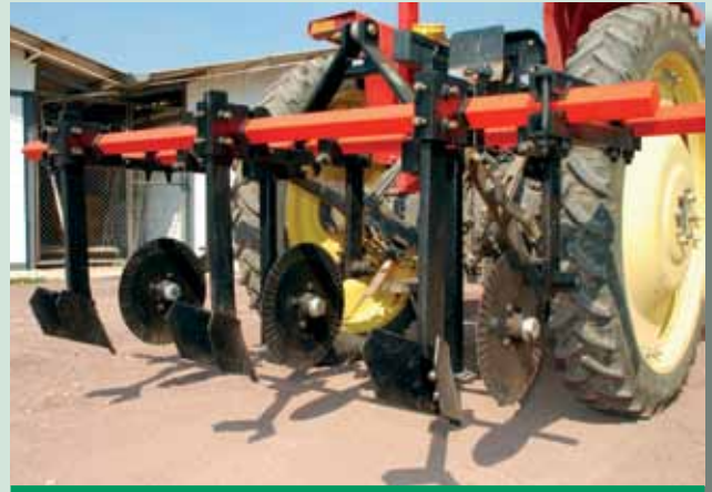
Figura 2. Cuerpos de la reformadora.
